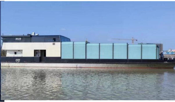
Заказчик: Jiaxing Weijia Shipyard Проектный заказ: 860квтч, туристическое судно Длина судна: 33 м Мощность двигателя: 90kw*2 Адрес: Чжецзян Сдача заказа: 2022
