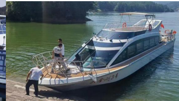
Заказчик: Jiangsu Haide Yachting Проектный заказ: 480квтч, туристическое судно Длина судна: 20.8 м Мощность двигателя: 50kw*2 Адрес: Фуцзянь Сдача заказа: 2021
