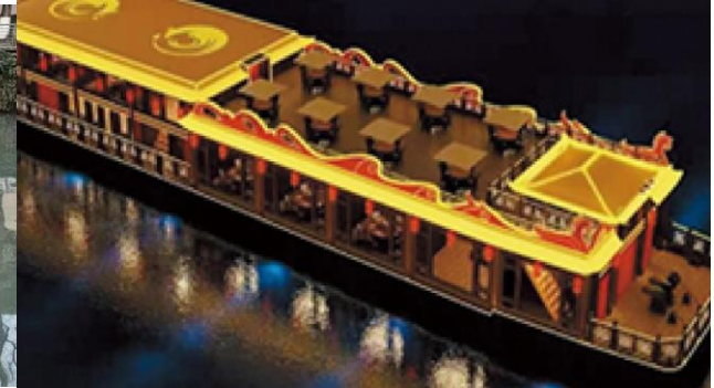
Заказчик: Hunan Haiquan Yachting Проектный заказ: 1400квтч, туристическое судно Длина судна: 50.8 м Мощность двигателя: 225kw*2 Адрес: Сычуань Сдача заказа: 2023
